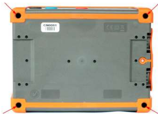
Рисунок 2 – Места пломбирования ТМ-2501
